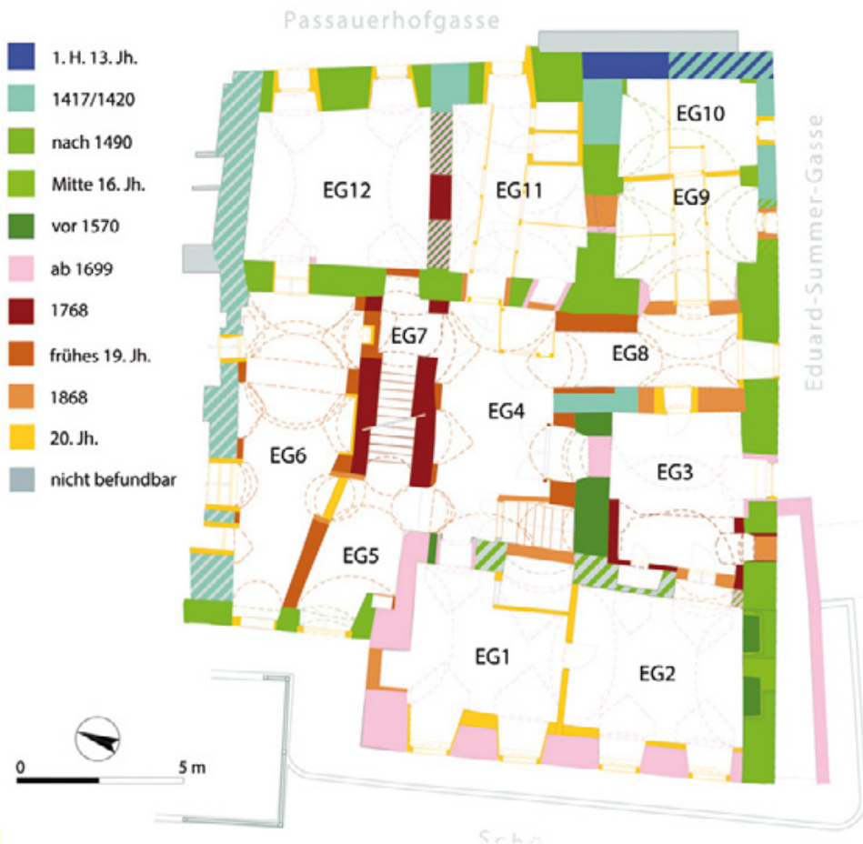
Abb. 36: Stein, Bürgerhaus Schürerplatz Nr. 10. Baualterplan des Erdgeschosses.
