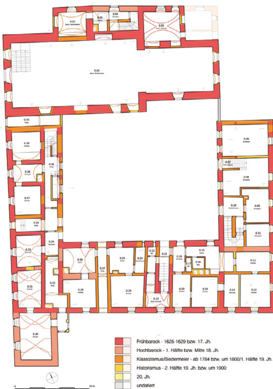
Abb. 30: Prugg Schloß, Kapuzinerkloster. Baualterplan des Erdgeschoßes.
