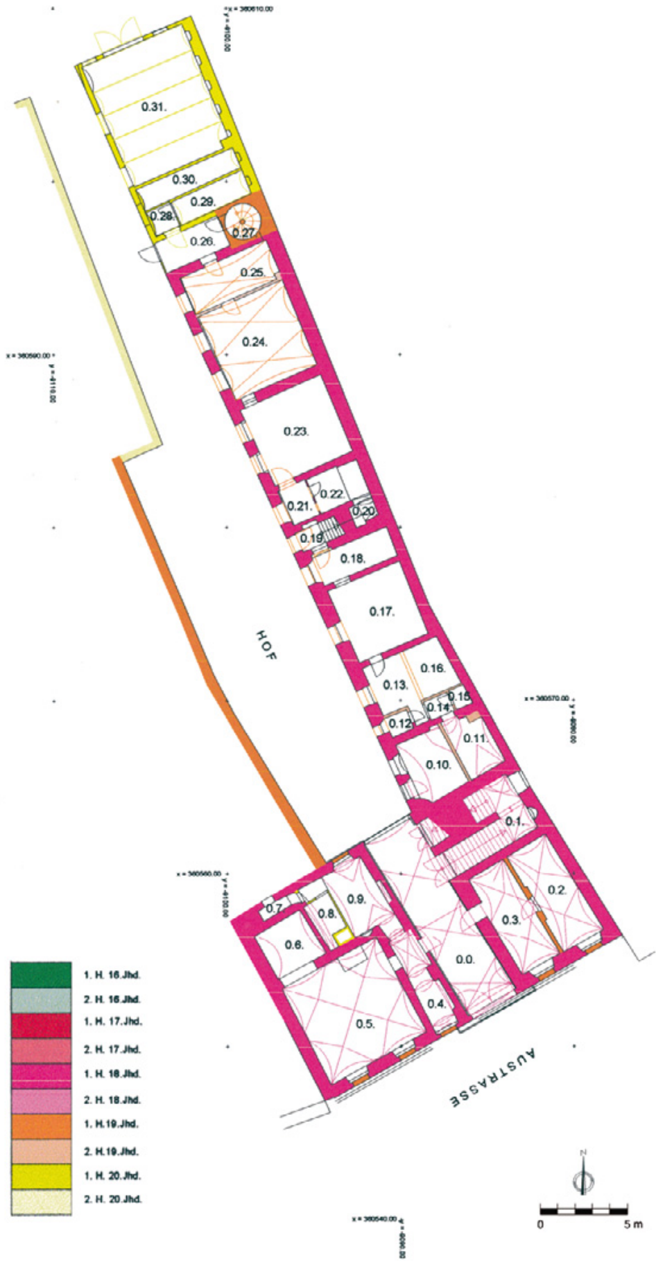
Abb. 43: Stockerau, Bürgerhaus Austrasse Nr. 14. Baualterplan des Erdgeschoßes.
