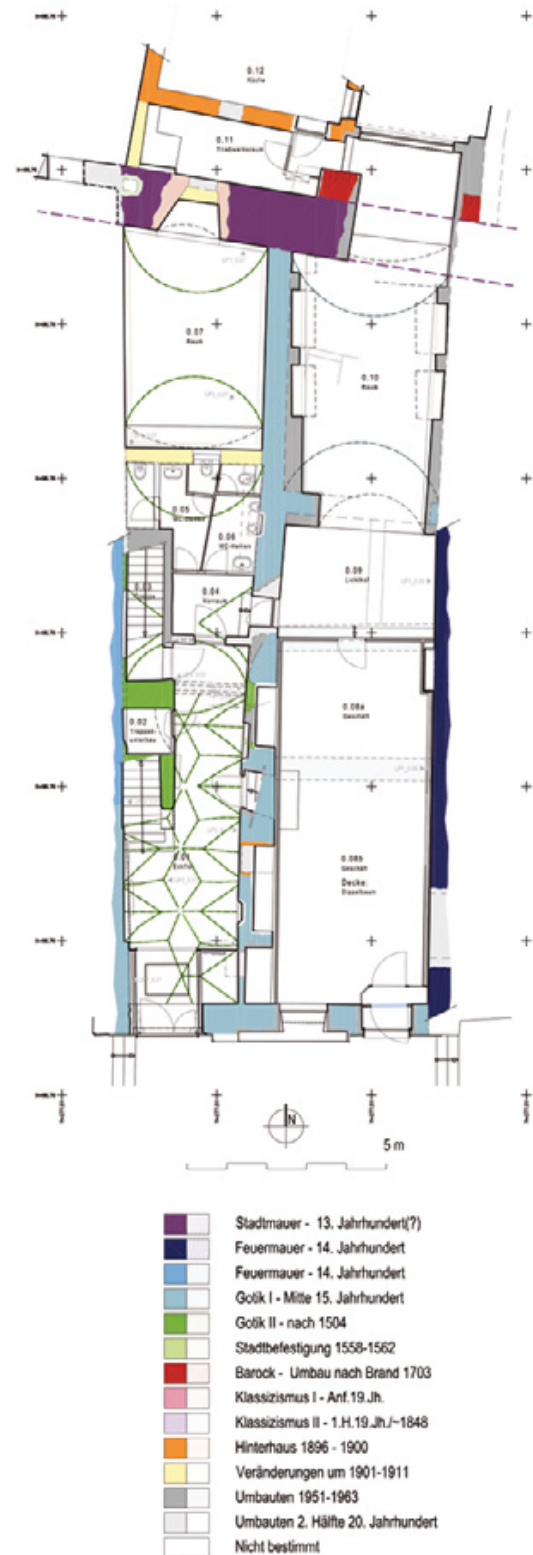
Abb. 4: Kufstein, Gasthof Goldener Hirsch. Baualterplan des Erdgeschoßes.
