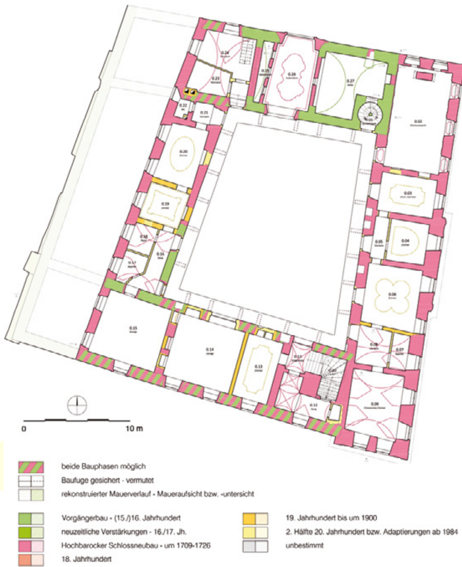
Abb. 34: Schmida, Schloss Schmida. Baualterplan des Erdgeschoßes.
