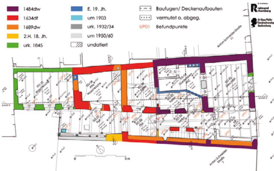
Abb. 2: Bregenz, Bürgerhaus. Baualterplan des Erdgeschosses.
