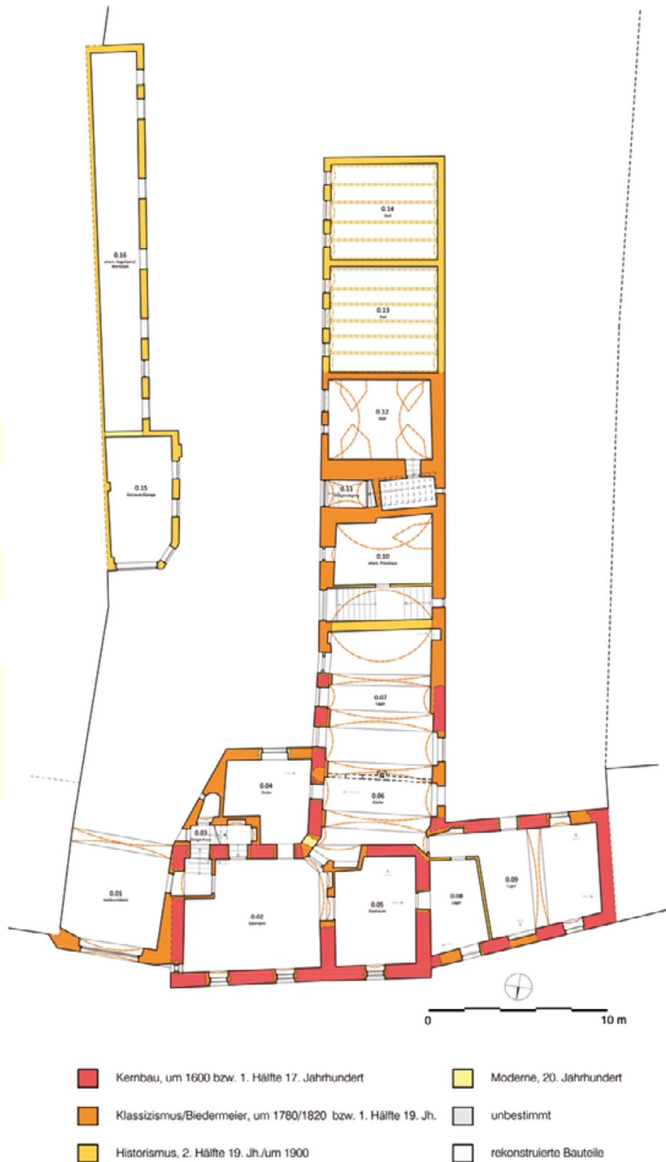
Abb. 44: Straß, Bürgerhaus. Baualterplan des Erdgeschoßes.
