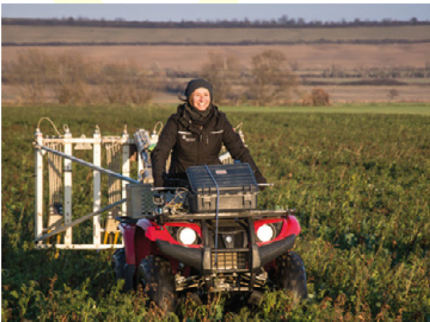
Abb. 3: Rechnitz. Motorisiertes Magnetometersystem mit acht Fluxgate-Sensoren im Einsatz.
