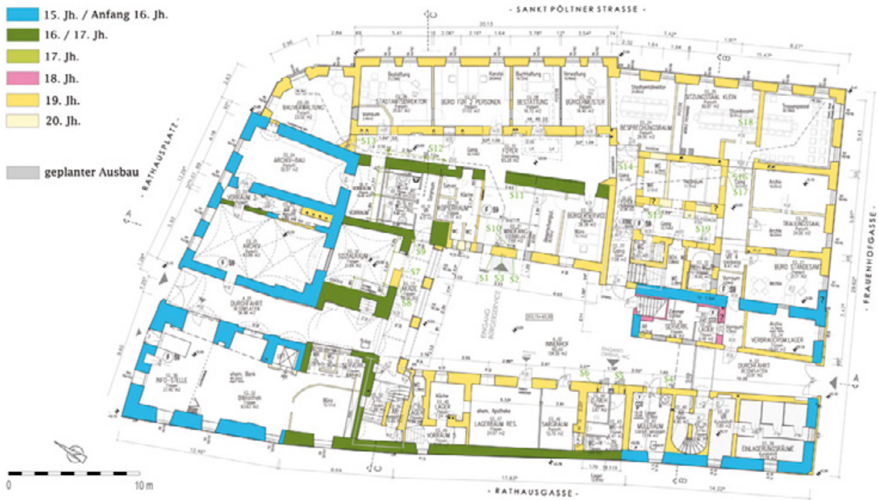
Abb. 26: Mautern an der Donau, Rathaus. Baualterplan des Erdgeschoßes.
