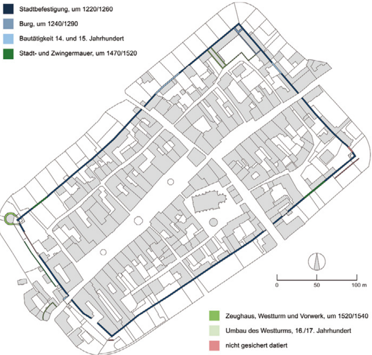
Abb. 12: St. Veit an der Glan, Stadtbefestigung. Baualterplan der Befestigungsanlagen.
