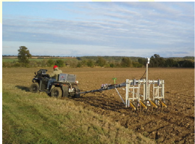
Abb. 4: Rechnitz. Motorisiertes Magnetometersystem mit sechs Cäsium-Sensoren im Einsatz.
