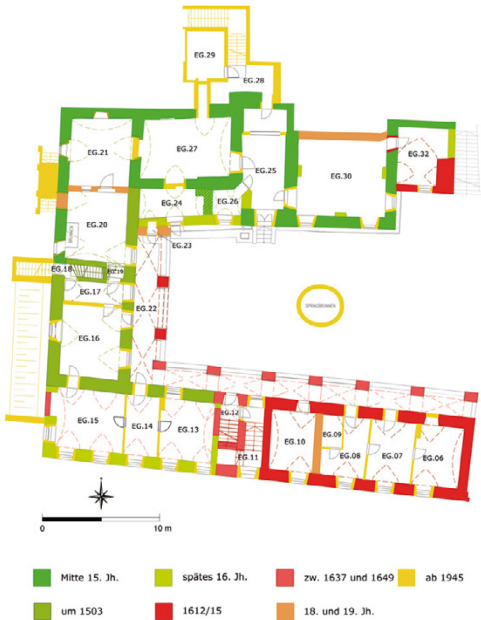
Abb. 32: Schlatten, Pfarrhof. Baualterplan des Erdgeschosses.
