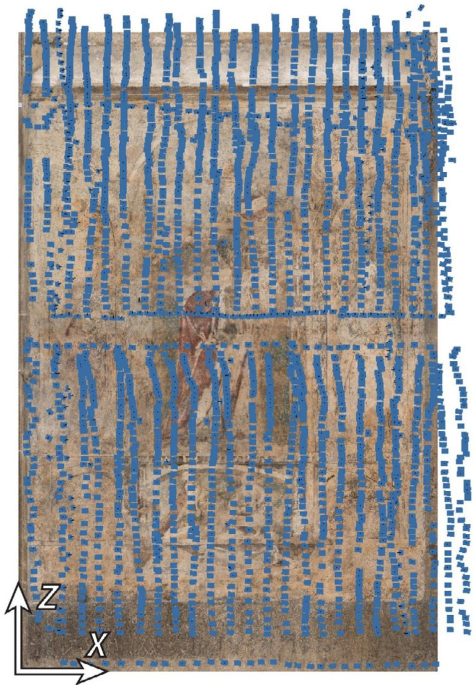
Abb. 5: Verteilung der Kamerapositionen für die 2.790 Aufnahmen vor dem Wandbild; die beiden horizontalen Lücken zeigen die Position der Gerüstbretter an; die Aufnahme einer weiteren vertikalen Reihe an Fotos ganz links wäre wünschenswert gewesen, wurde aber durch das Gerüst und die angrenzende Wand verhindert
