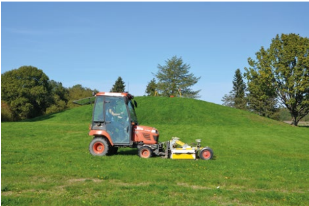
48. Motorisiertes Bodenradar im Einsatz in Norwegen
