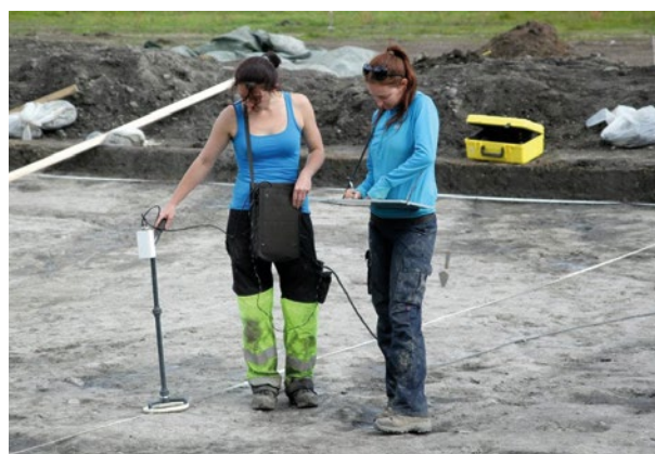
53. In-situ-Messungen der magnetischen Suszeptibilität, 2012 im Zuge der Ausgrabungen eines Teiles der Siedlung auf Heimdaljordet.
