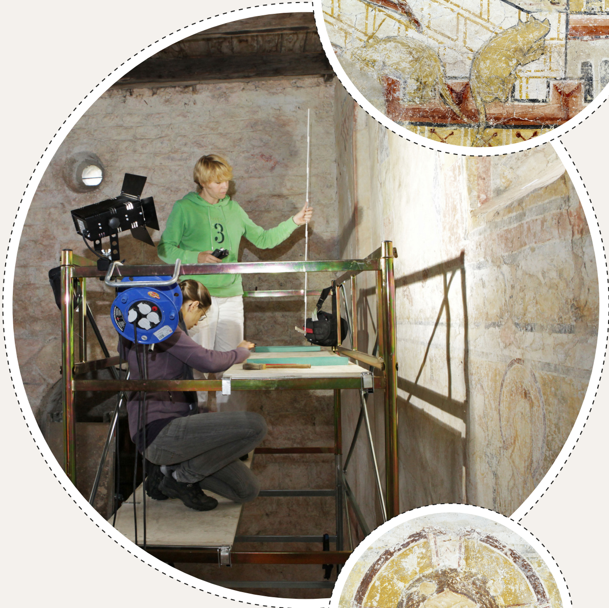
Messung der Oberflächenleitfähigkeit an den romanischen Wandmalereien in der Johanneskapelle in Pürgg
