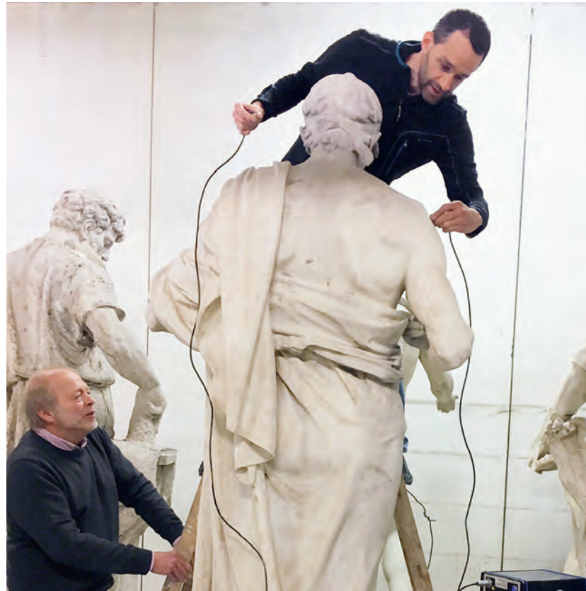
Abb. 4: Durchführung der Ultraschallmessung in Zusammenarbeit mit Johannes Weber und Farkas Pintér
