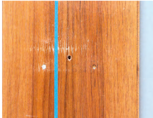
Abb. 3: Detail der Befundfläche, links Zwischenzustand nach Kittung eines Bohrlochs, rechts Vorzustand
