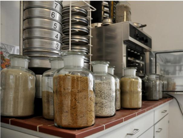
Abb. 152: Forschungsprojekt Sandkataster Österreich des Bundesdenkmalamtes, Erstellen der Korngrößenverteilungslinie der Sande mittels Vibrationsiebmaschine
