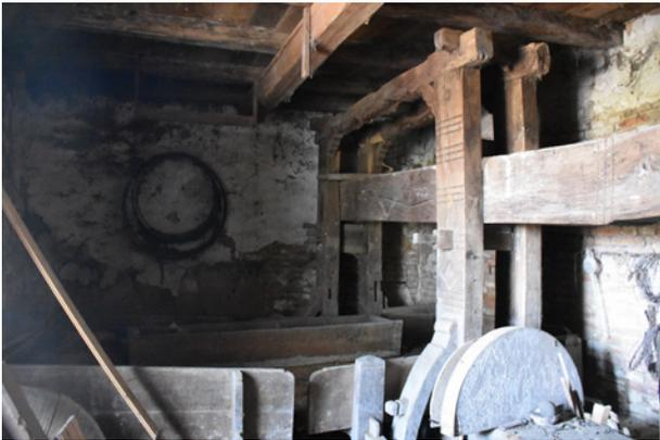
Abb. 74: Ketzelsdorf, NÖ, *Alte Geringen*, Einblick in das Presshaus Obj.-Nr. 48 gegen Osten mit der Baumpresse rechts im Bild (bez. 1803)
