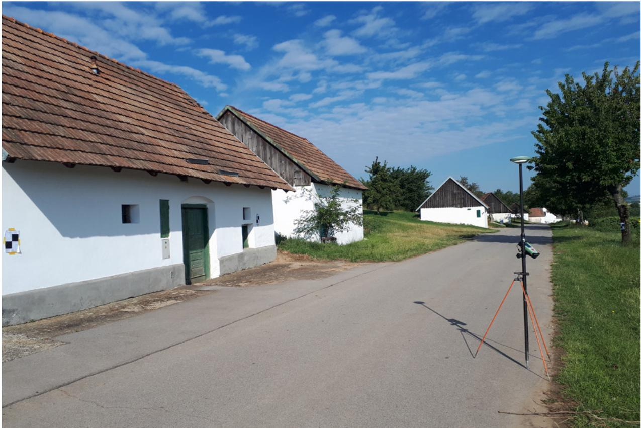
Abb. 99: Vermessung der Außenräume einer Kellergasse mittels GPS
