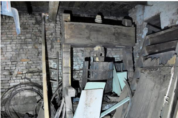
Abb. 75: Ketzelsdorf, NÖ, *Alte Geringen*, Presshaus Obj.-Nr. 48, Mittelspindelpresse, bez. 1831
