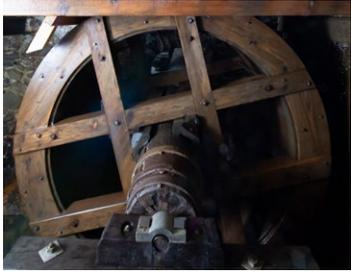
**Im Rahmen der Wiederherstellungsarbeiten** in den Jahren 2021 und 2022 wurde das große Wasserrad samt Fluder neu aus Tannenholz errichtet. Die beiden anderen Wasserräder wurden instand gesetzt und sämtliche historischen Eisenbeschläge, die charakteristisch für Dimension und Bauart der wasserführenden Anlagenteile sind, wurden restauriert und wiederverwendet, damit die Anlage ihre typischen Details beibehält. Alle drei historischen Grindelbäume konnten auch substantiell erhalten werden.
