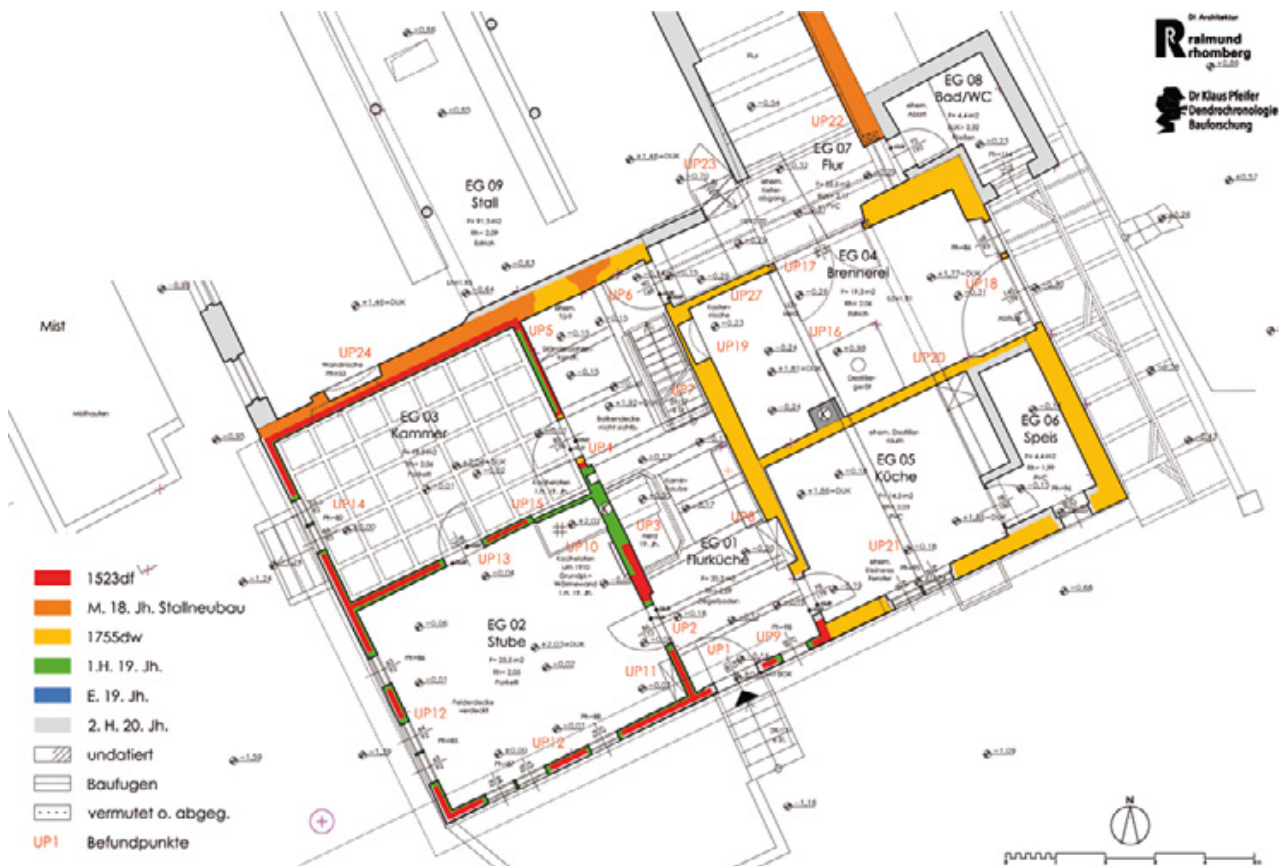
Abb. 4: Lochau, Milzhaus. Baualterplan des Erdgeschoßes.
