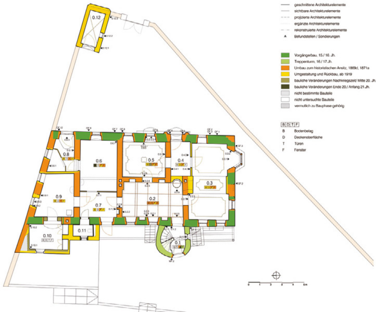
Abb. 12: Schwarz, Minkus-Schlössl. Baualterplan des Erdgeschoßes.
