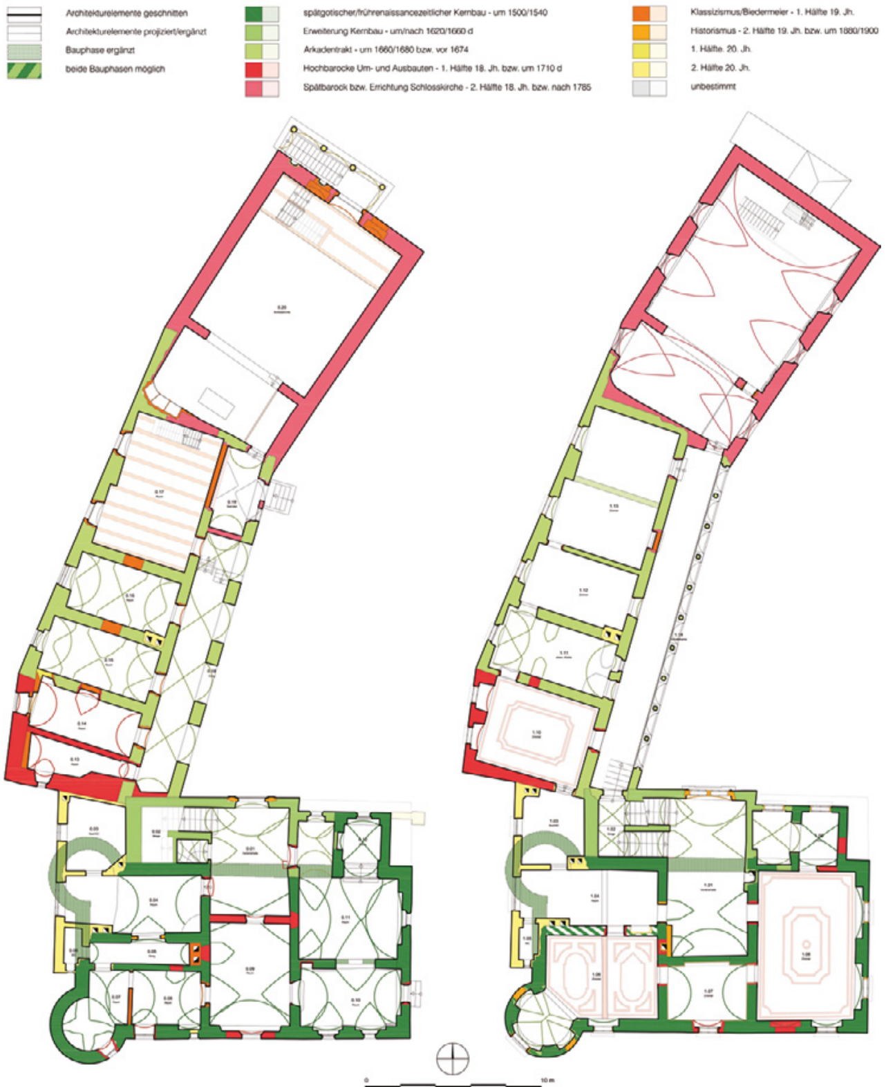
Abb. 2: Eggendorf, Schloss. Baualterplan des Erdgeschoßes (links) und des 1. Obergeschoßes (rechts).
