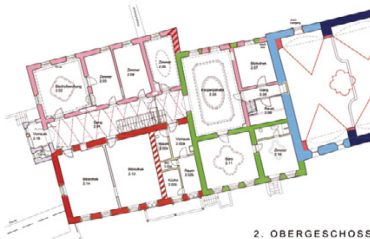
Abb. 4: Fügen, Widum. Bualterpläne des Erdgeschoßes (mit Pfarrkirche), 1. Obergeschoßes und 2. Obergeschoßes.
