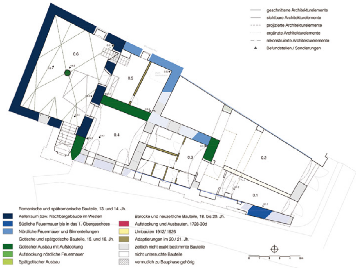
Abb. 6: Innsbruck, Gasthaus »Zum Einhorn«. Baualterplan des Erdgeschoßes.
