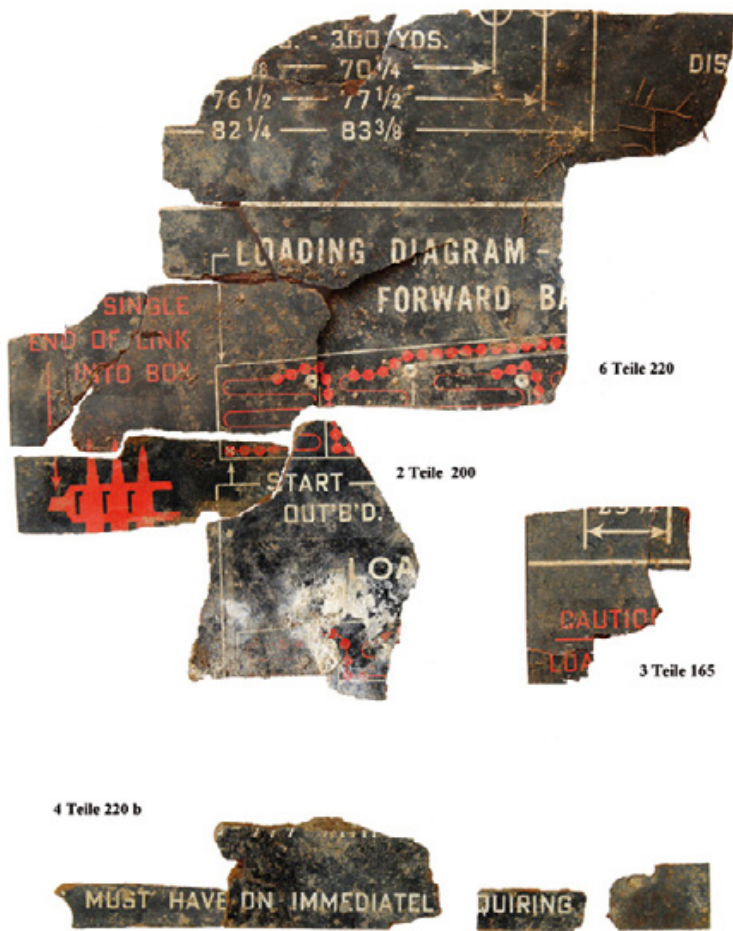
Abb. 5: Hohenthurn (Mnr. 75419.17.01). Zusammengefügtes Ladediagramm für die Bordwaffen der P-51 Mustang. Im Maßstab 1 : 2.
