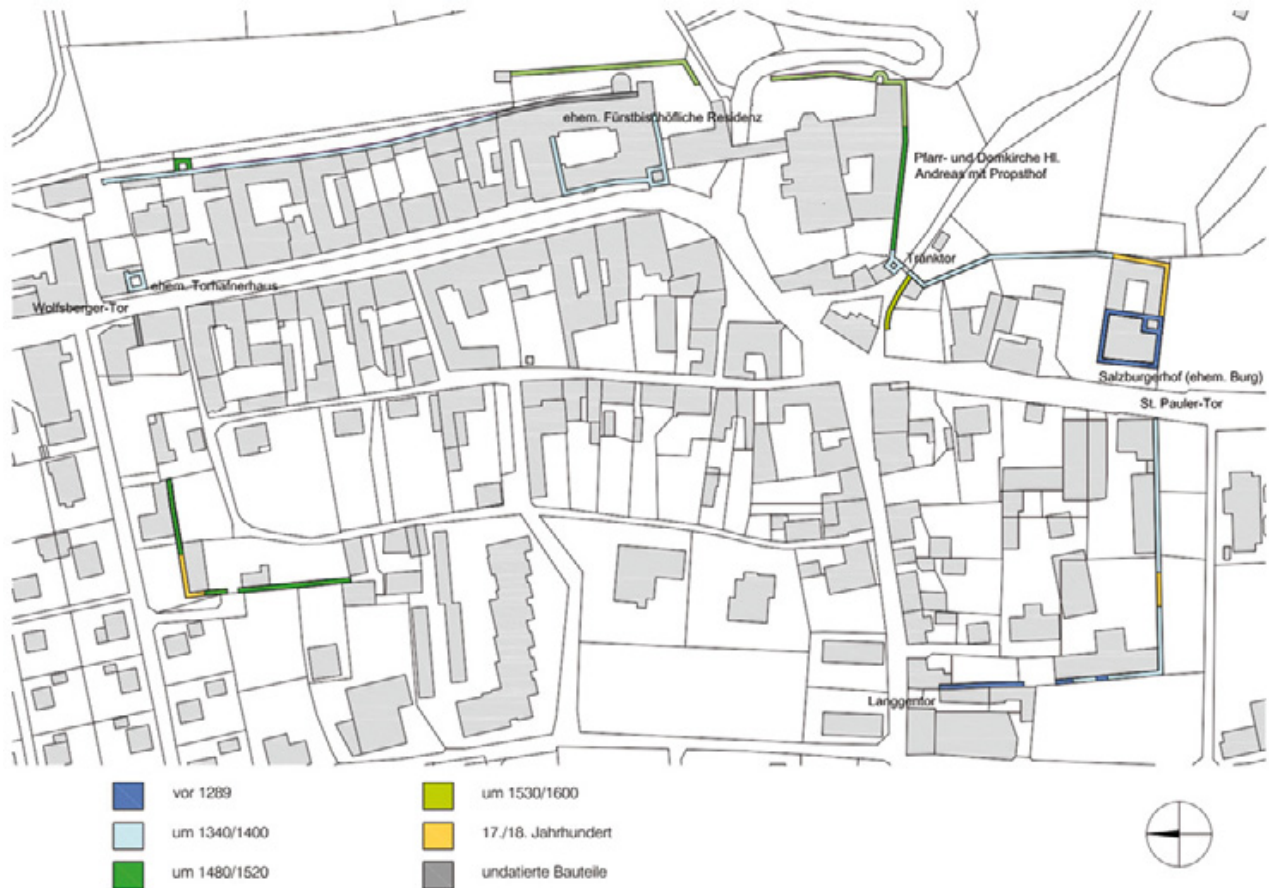
Abb. 7: St. Andrä, Stadtbefestigung. Baulterplan der erhaltenen Baureste.
