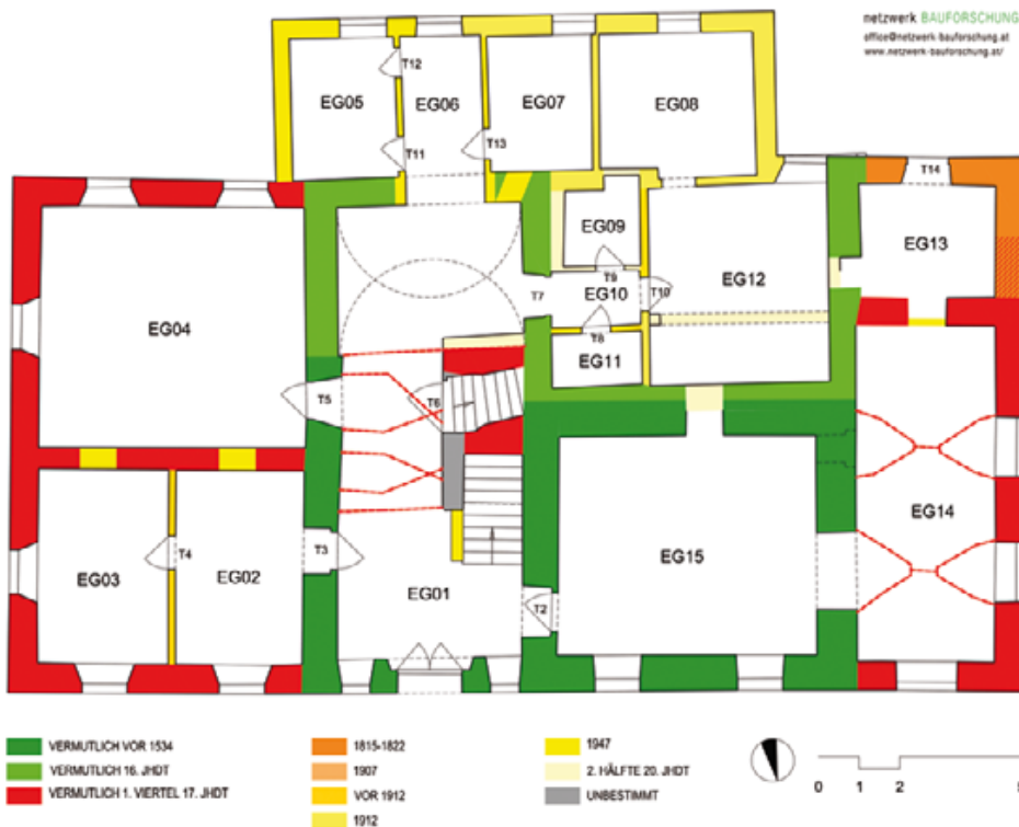
Abb. 2: Amstetten, Schloss Edla. Baualterplan des Erdgeschoßes.
