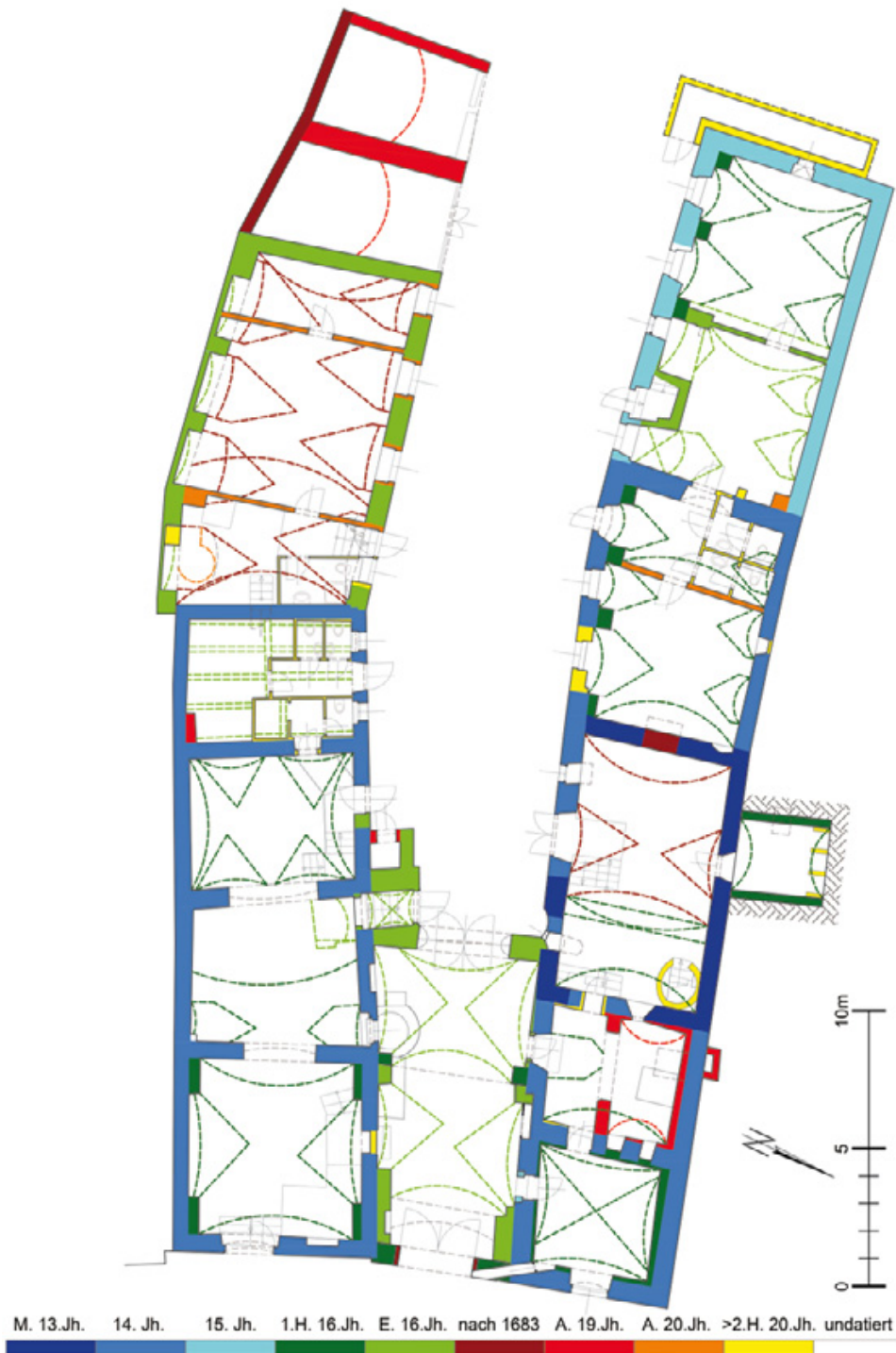
Abb. 25: Perchtoldsdorf, Regenharthaus. Baualterplan des Erdgeschoßes.
