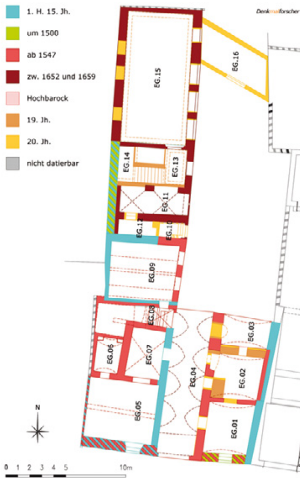
Abb. 36: Traismauer, Rathaus. Baualterplan des Erdgeschosses.
