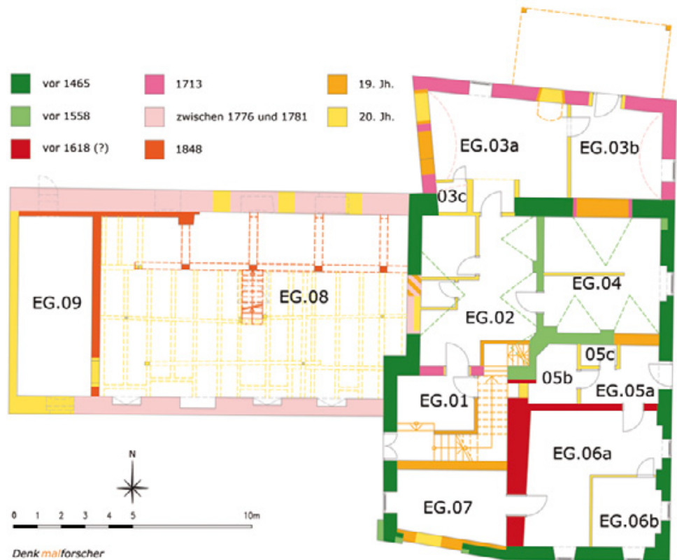
Abb. 23: Mödling, Putschermühle. Baualterplan des Erdgeschoßes.
