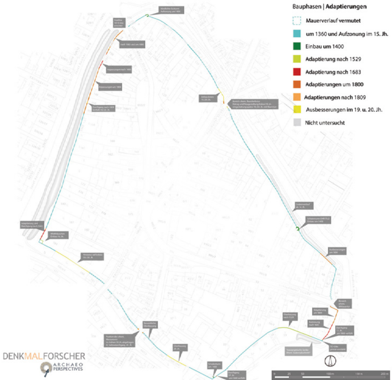
Abb. 10: Großenzersdorf, Stadtbefestigung. Bualterplan der Befestigungsanlagen.
