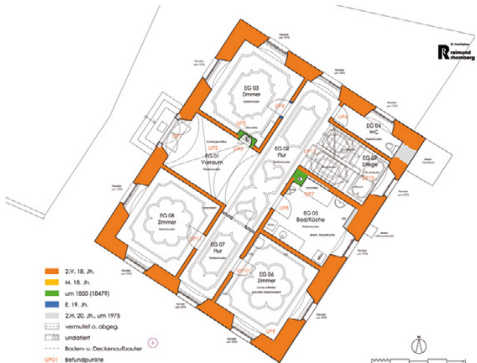
Abb. 2: Bregenz, Praebendehaus. Baulterplan des Erdgeschoßes.
