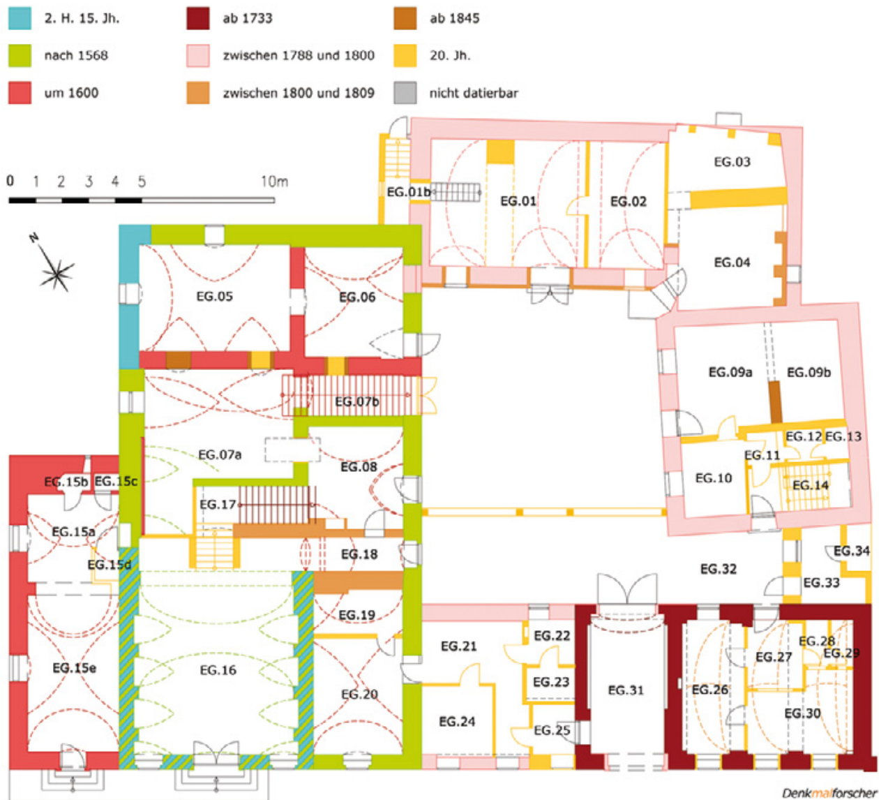
Abb. 26: Persenbeug, Rathaus. Baualterplan des Erdgeschoßes.
