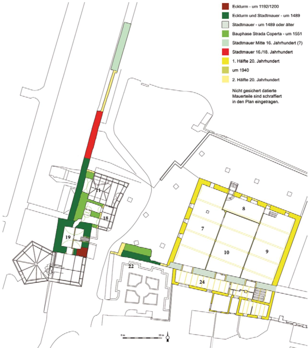
Abb. 53: Wiener Neustadt, Kasematten. Baualterplan des Obergeschoßes.
