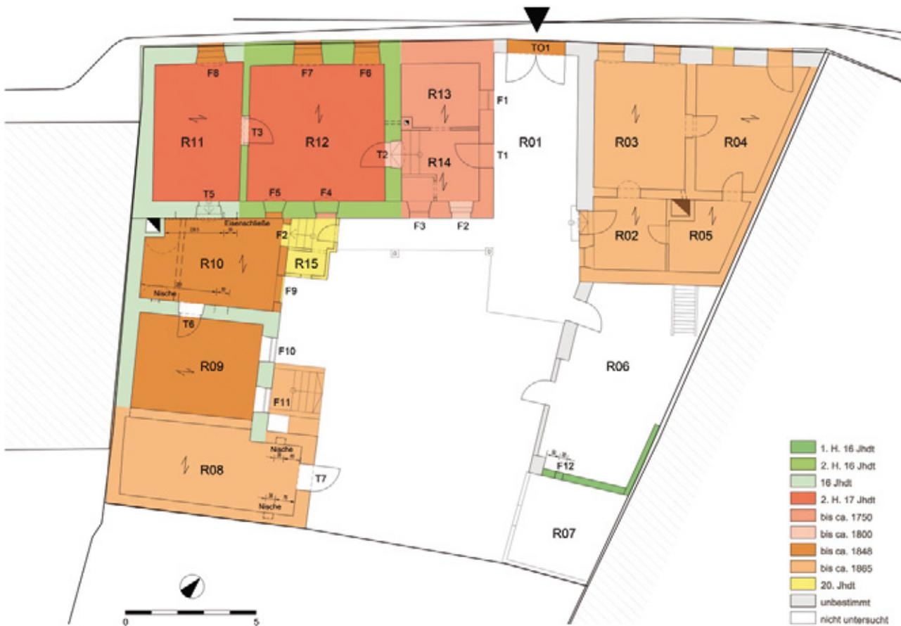
Abb. 48: Weidling, Weinbauerhaus Hauptstraße Nr. 13. Baualterplan des Erdgeschoßes.
