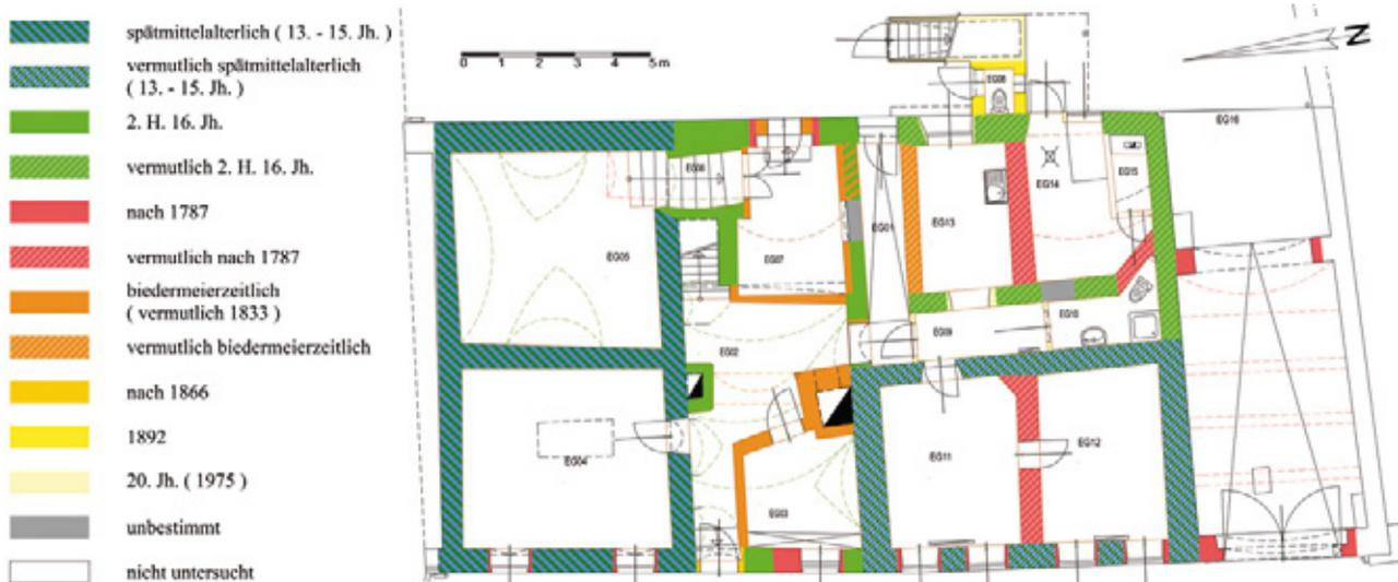
Abb. 43: St. Pölten, Bürgerhaus Lederergasse Nr. 7. Baualterplan des Erdgeschoßes beziehungsweise Souterrains/Kellergeschoßes.
