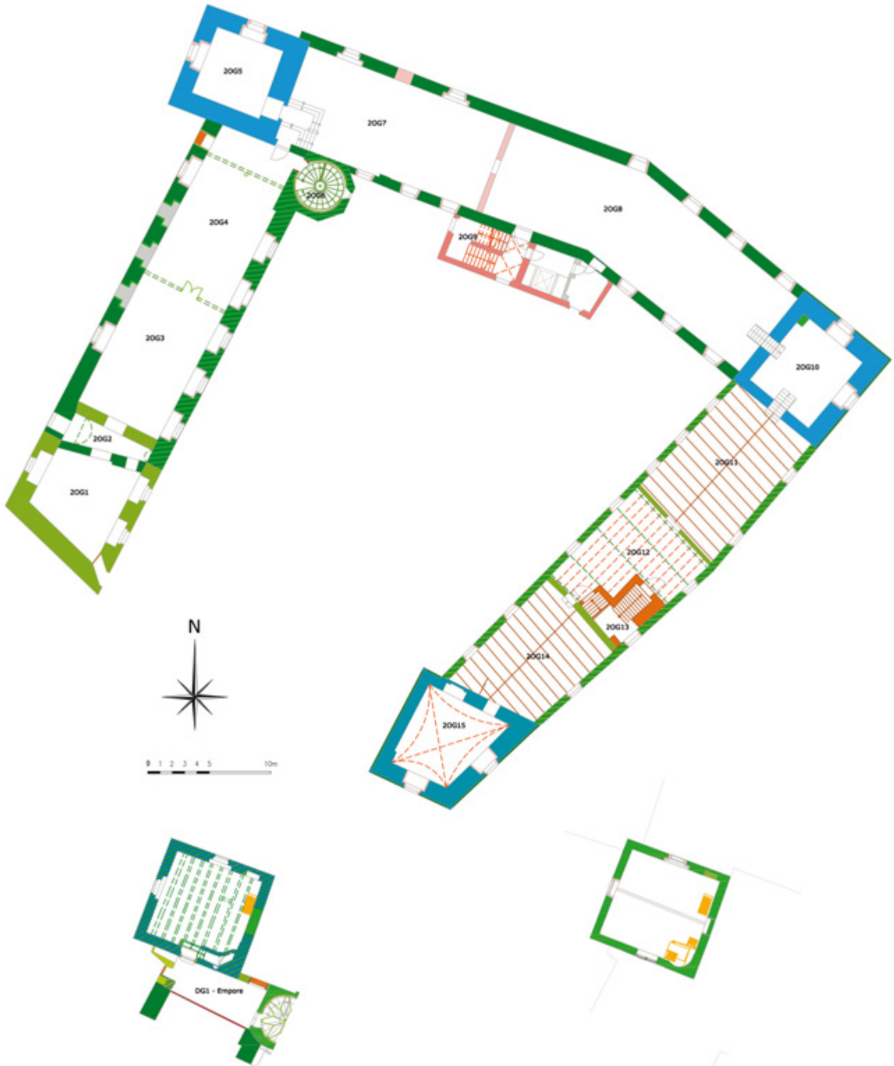
Abb. 22 Orth an der Donau, Schloss. Bauphasenplan des 2. Obergeschoßes sowie des 3. und 4. Obergeschoßes (Nordwestturm).
