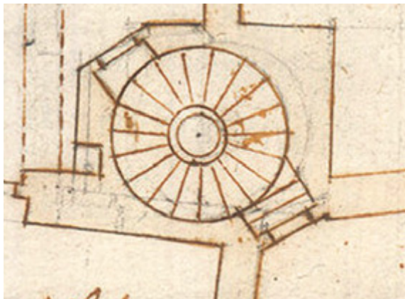
Abb. 212 Wien, Hofburg. Ausschnitt mit Grundriss des Wendeltreppenturmes (1540–1542) aus der planmäßigen Bestandsaufnahme des Gartenareals nordöstlich der Alten Burg von Giovanni Battista Pieroni (?), 1640.
