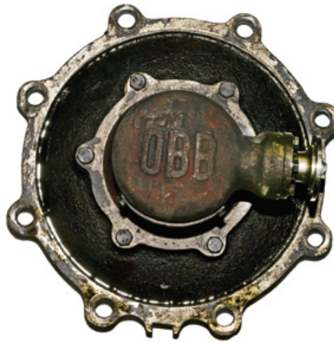
Abb. 153: Rollenschlagerdeckel mit Öl, Winkelgetriebe, Obj. Nr. 224.
