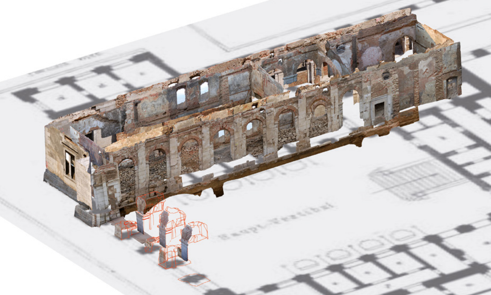
Abb. 28: Kassenhalle und Schalterbereich Südbahnhof II, Südflanke; Projektion der photogrammetrischen Aufnahme auf den historischen Plan Flattichs.
